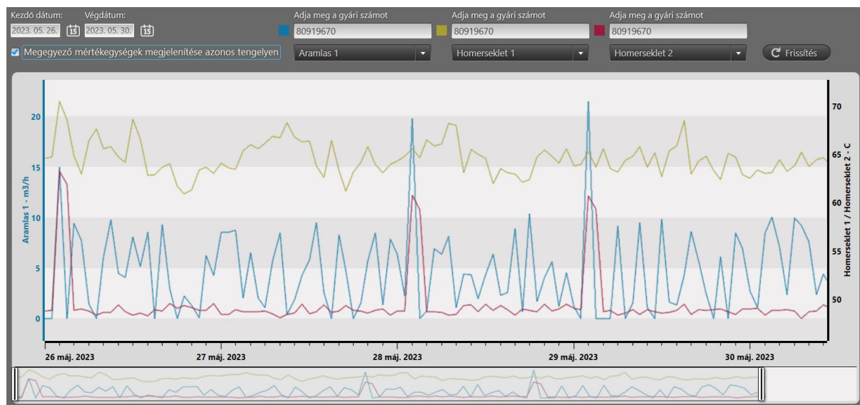
6. ábra: Óránként megjelenített V1 áramlási és T1-T2 hőmérsékleti adatok
