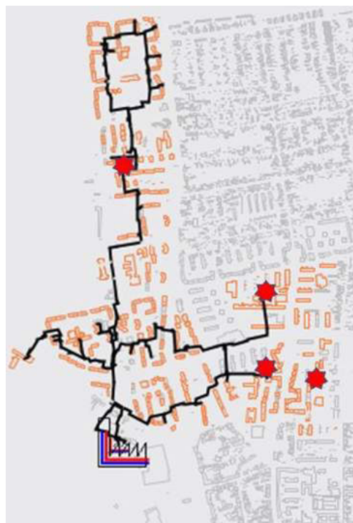
1. ábra Szigetüzemű kazánházak összevonása
