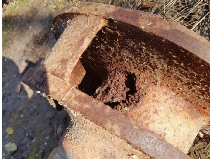
12. ábra: Kavitáció következtében tönkrement járókerék
