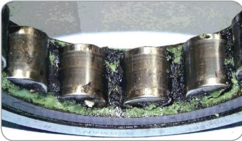
Elektromos áramkisülés következtében bomlásnak indult kenőanyag
